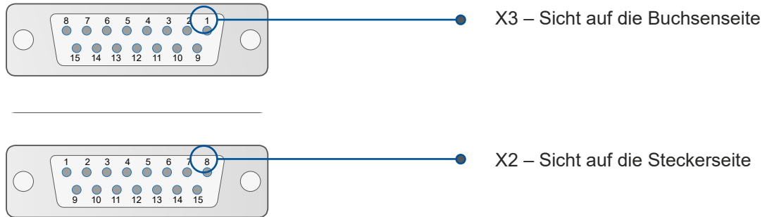
Abbildung 5: PIN-Bezeichnung Stecker und Buchsen
